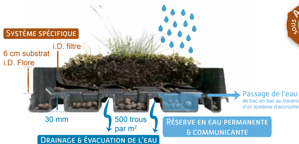
Coupe transversale de l' HYDROPACK®
